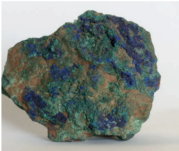
Afb. 4: Boven: Kopermineeraal bestaande uit gebande malachiet (groen) en azuriet (blauw) op een fijn, kleiachtig gesteente; het mineraal moet dus worden verbrijzeld en het malachiet moet van de steriele fasen worden gescheiden om metaal te produceren; afzetting van Mindouli, lengte 10 cm. Onder: monster botryoidale malachiet; afzetting van Boko-Songho, lengte 8 cm (Th. De Putter 2015).
